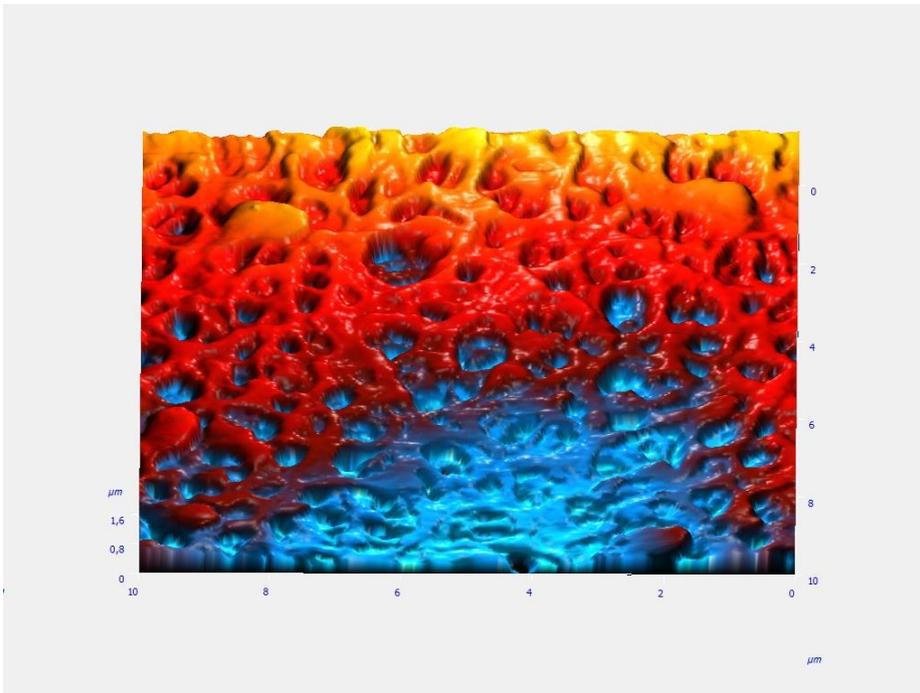
Нанолава. Мембранный фильтр. Размер пор 0,22 мкм. Размер кадра 10x10 мкм. Полуконтактный режим на воздухе. 3D-изображение.
