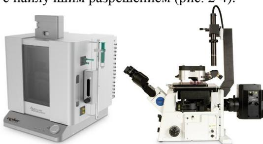
Рис. 1. Общий вид АСМ Asylum Research Cypher ES (слева) и MFP-3D-BIO (справа).
