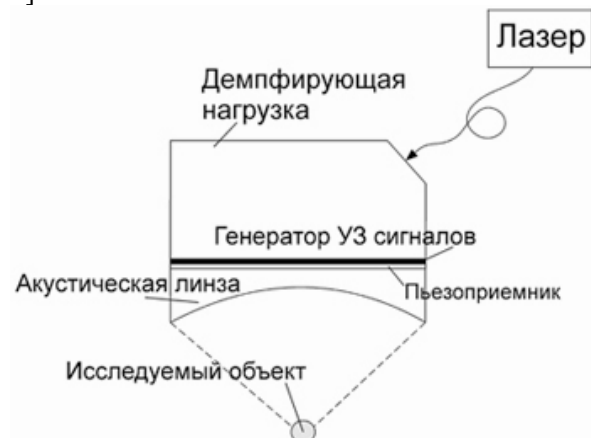
Рис. 1. Схема расположения элементов в антенне.
