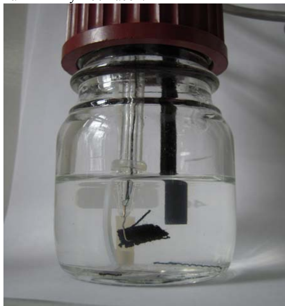
Рис. 4. Водородный электрод, интегрированный в жидкую среду.
