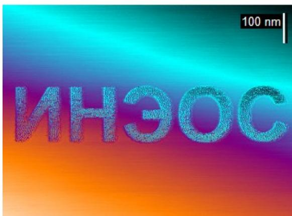
Рис. 1. Название института, выгравированное на графите методом локального анодного окисления. Изображение получено с помощью атомно-силового микроскопа «ФемтоСкан».
