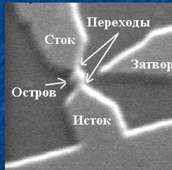
Одноэлектронный транзистор из высокодопированного КНИ.
