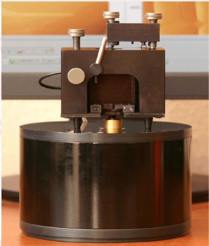
Мультифункциональный сканирующий зондовый микроскоп «ФемтоСкан»
