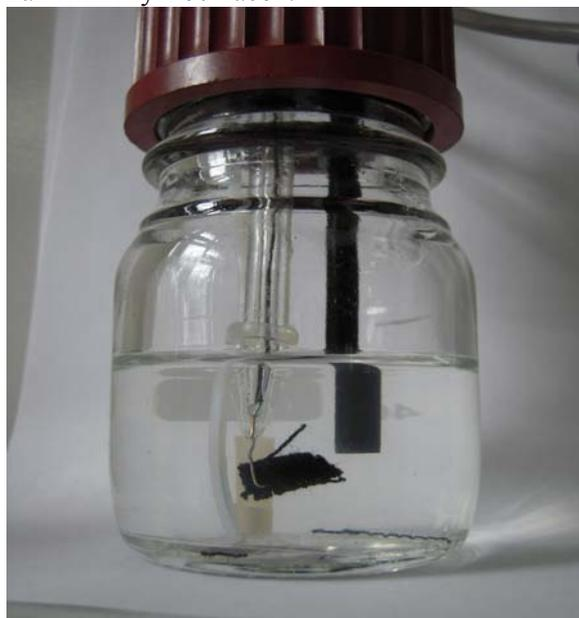
Рис. 4. Водородный электрод, интегрированный в жидкую среду.
